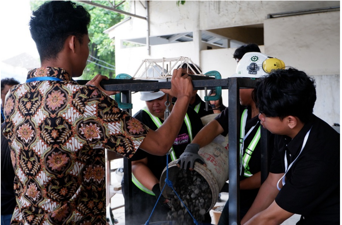
Uji pembebanan desain jembatan balsa mahasiswa Teknik Sipil ITN Malang. (Foto: Mita/Humas ITN Malang).
